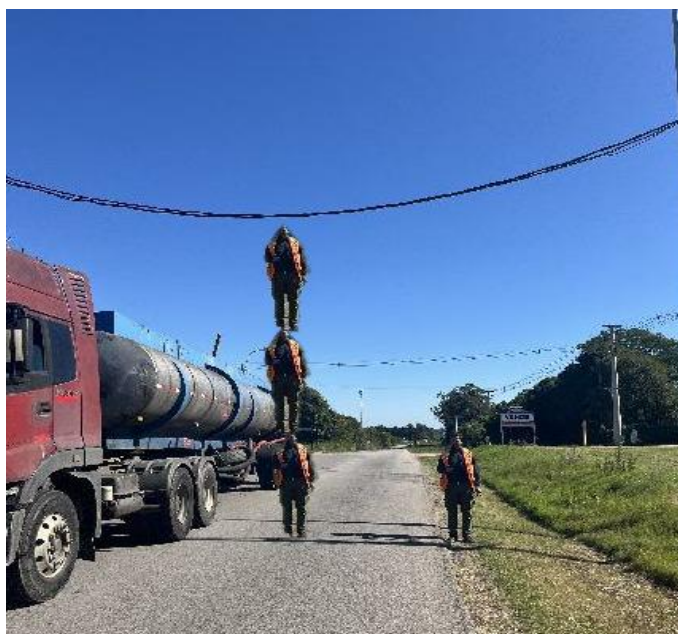
Ilustración 2- Estimación visual de altura de cable utilizando Photoshop
